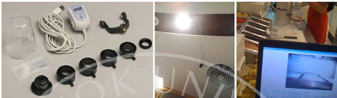
ภาพที่ 3.10 : แสดง อุปกรณ์กล้องโมติแคม (Moticam) และการติดตั้งกล้องบนฝ้าเพดาน
