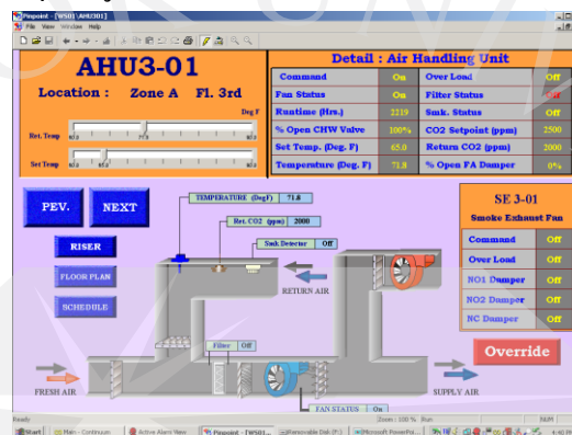
ภาพที่ 4.26 : การปรับตั้งค่าอุณหภูมิภายในพื้นที่ปรับอากาศให้เหมาะสม
