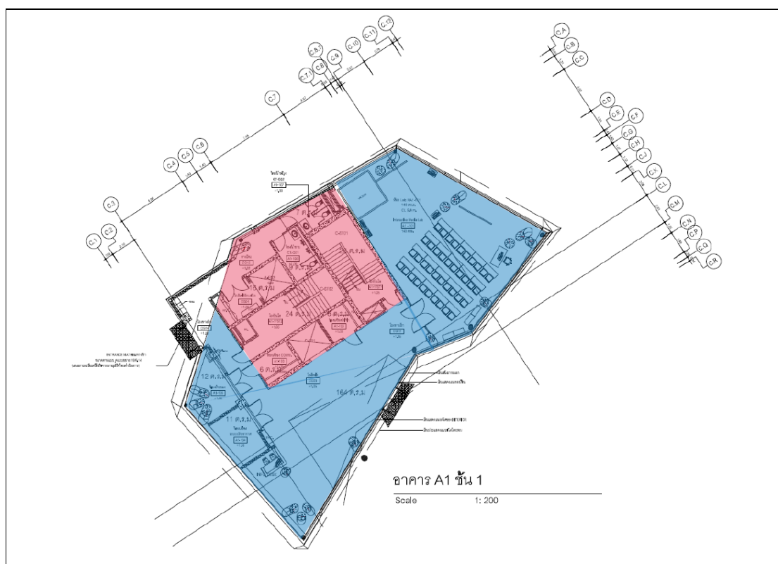
ภาพที่ 3.17: แสดงรายละเอียดชั้นที่ 1 ด้านหน้าอาคารติดกับถนนพหลโยธิน ภายในอาคาร มีพื้นที่ห้องเรียน และห้องเครื่องไฟฟ้า ตรงกลางเป็นพื้นที่โถงลิฟต์และโถงทางเดิน เป็นพื้นที่ปรับอากาศ
