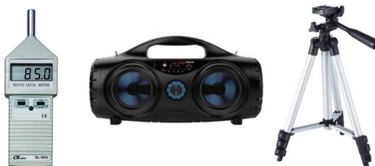
ภาพที่ 3.6: เครื่องวัดระดับเสียง Lutron SL-4010 ลำโพง และอุปกรณ์ประกอบ
