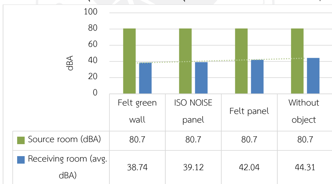
ภาพที่ 4.8: เปรียบเทียบคุณสมบัติการซับเสียงของวัสดุทดแลงโดยการวัดค่าด้วยระดับเสียง Leq
