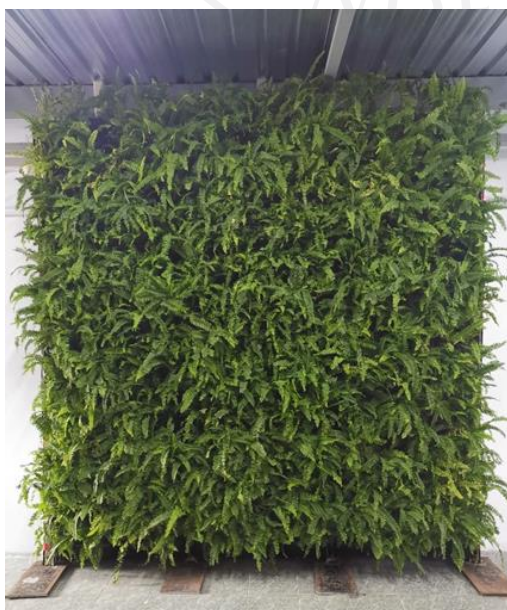
ภาพที่ 4.6: การทดสอบคุณสมบัติการซับเสียงของสวนแนวตั้งแผงสีกหลาด (Felt panel system green wall)
