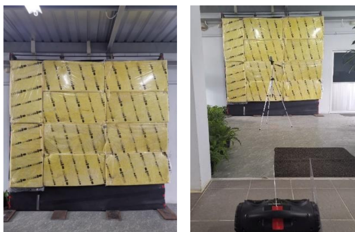
ภาพที่ 4.3: การทดสอบคุณสมบัติการซับเสียงของแผ่นฉนวน ISO NOISE
