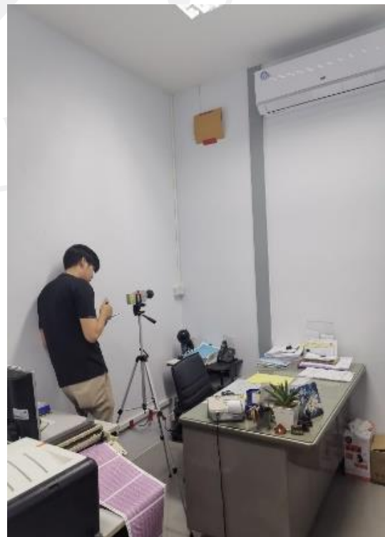
ภาพที่ 4.1: วัดผลจากห้องกำเนิดเสียง (Source Room) และวัดผลจากห้องรับเสียง (Receiving Room)
