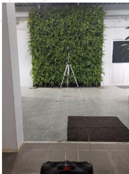
ภาพที่ 4.6: การทดสอบคุณสมบัติการซับเสียงของสวนแนวตั้งแผงสีกหลาด (Felt panel system green wall)
