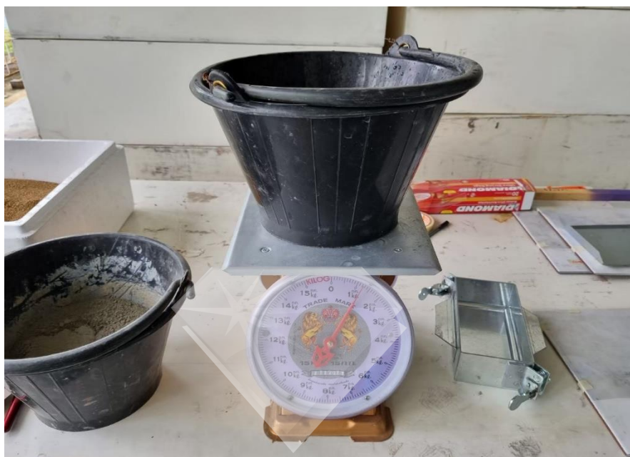
ภาพที่ 3.18: ขั้นตอนที่ 2 ผสมวัสดุดิบให้เข้ากันและพักไว้เป็นเวลา 15 นาที สังเกตให้ปูนและกากข้าว มอลต์จับตัวกันจึงนำมาขึ้นรูป
