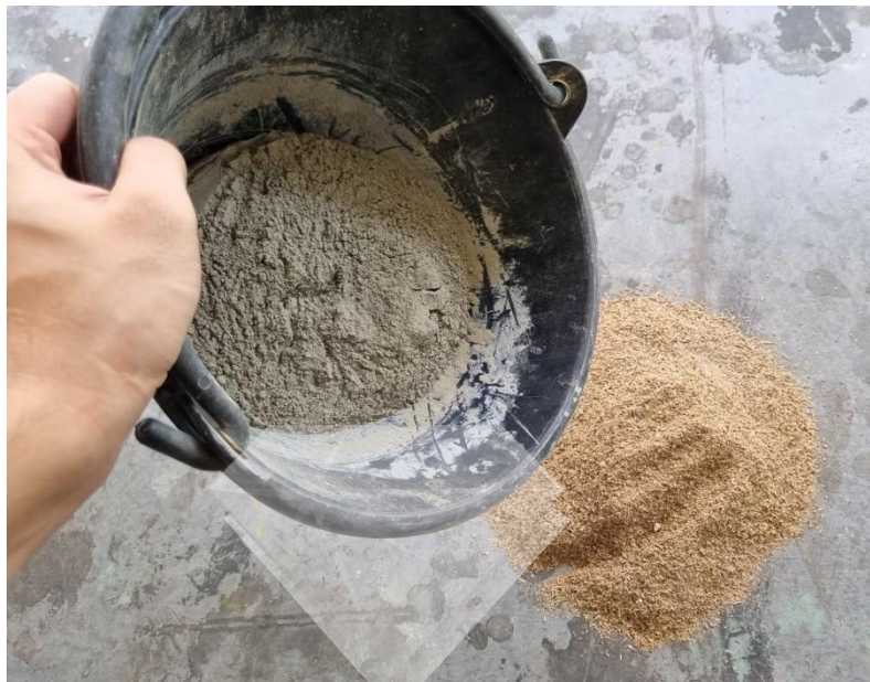
ภาพที่ 3.15: ขั้นตอนที่ 2 ผสมวัตถุดิบให้เข้ากันและพักไว้เป็นเวลา 15 นาที สังเกตให้ปูนและกากข้าว มอลต์จับตัวกันจึงนำมาขึ้นรูป
