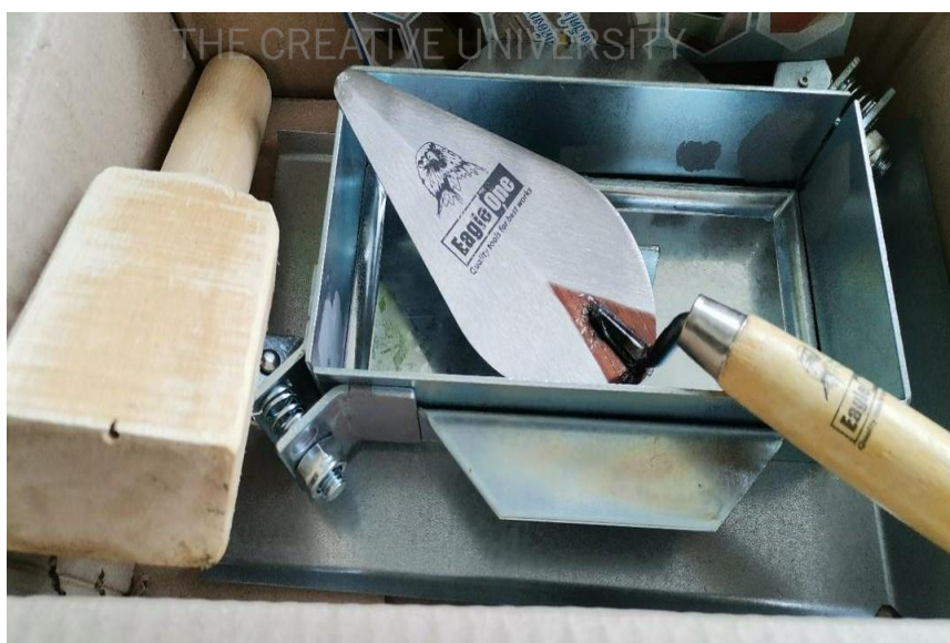
ภาพที่ 3.5: แม่พิมพ์อิฐรูปทรงสี่เหลี่ยมผืนผ้า ขนาด 100 X 200 X 60 มิลลิเมตร
