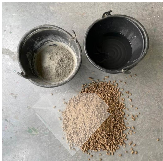
ภาพที่ 3.12: ขั้นตอนที่ 2 ผสมวัตถุดิบให้เข้ากันและพักไว้เป็นเวลา 15 นาที สังเกตให้ปูนและกากข้าว มอลต์จับตัวกันจึงนำมาขึ้นรูป
