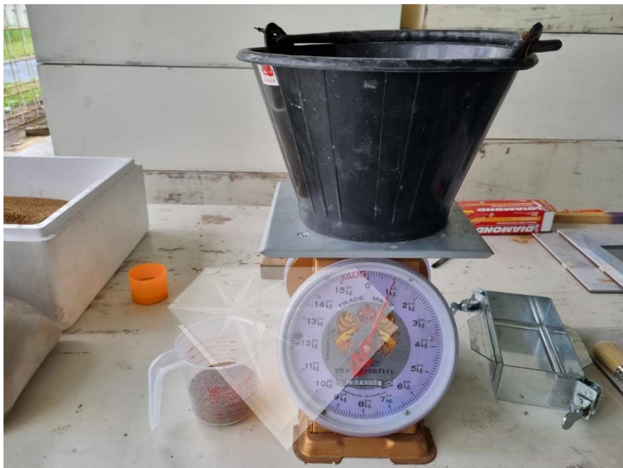
ภาพที่ 3.24: ขั้นตอนที่ 2 ผสมวัสดุดิบให้เข้ากันและพักไว้เป็นเวลา 15 นาที สังเกตให้ปูนและกากข้าว มอลต์จับตัวกันจึงนำมาขึ้นรูป
