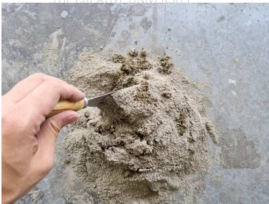
ภาพที่ 3.24: ขั้นตอนที่ 2 ผสมวัสดุดิบให้เข้ากันและพักไว้เป็นเวลา 15 นาที สังเกตให้ปูนและกากข้าว มอลต์จับตัวกันจึงนำมาขึ้นรูป
