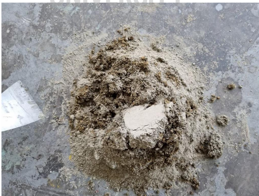
ภาพที่ 3.21: ขั้นตอนที่ 2 ผสมวัสดุดิบให้เข้ากันและพักไว้เป็นเวลา 15 นาที สังเกตให้ปูนและกากข้าว มอลต์จับตัวกันจึงนำมาขึ้นรูป
