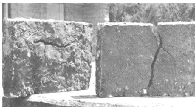
(ข) แสดงให้เห็นแนวแตกในแท่งดินที่ยังมีฟางผสมแต่ก็ยังไม่แตกขาดกัน (ซ้าย) และแสดงให้เห็นแท่งดินที่ไม่มีฟางผสมเพื่อยึดเหนี่ยวเลย ทำให้แตกแยกเป็น 2 ส่วน (ขวา)
