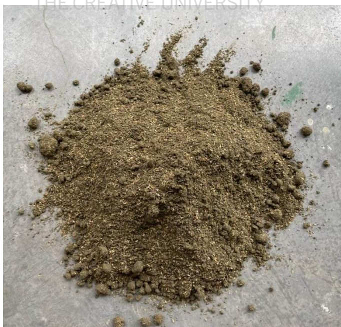
ภาพที่ 3.12: ขั้นตอนที่ 2 ผสมวัตถุดิบให้เข้ากันและพักไว้เป็นเวลา 15 นาที สังเกตให้ปูนและกากข้าว มอลต์จับตัวกันจึงนำมาขึ้นรูป
