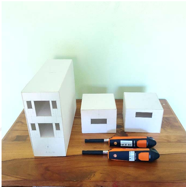
ภาพที่ 3.28: ภาพแสดงการทดลองการวัดค่าความเร็วลมจากแบบจำลองกล่องกระดาษ
