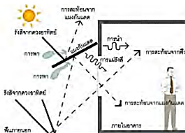
ภาพที่ 2.32: พฤติกรรมการถ่ายเทความร้อนจากแผงกันแดดเข้าสู่ภายในอาคาร
