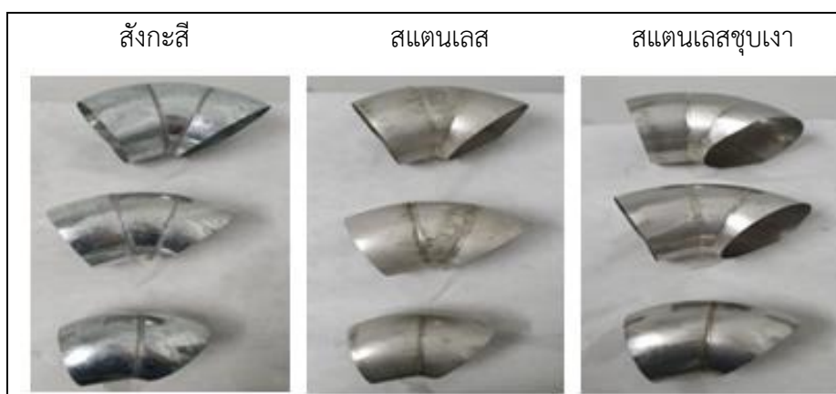
ภาพที่ 1.10: ข้องอ แบ่งออกเป็น 3 แบบ
