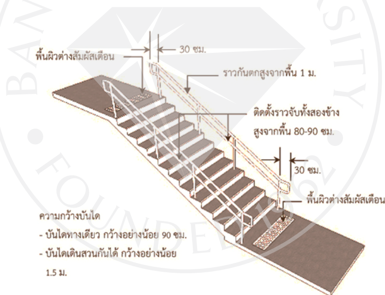
ภาพที่ 2.14: ระยะของบันไดที่เหมาะสมสำหรับผู้สูงอายุ
