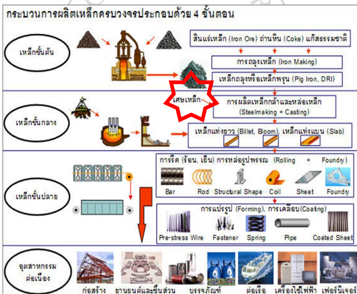
ภาพที่ 1.8 : ภาพแสดงลำดับขั้นของเศษเหล็ก
